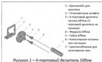
1. Закрепите кронштейн (1) в подходящей точке в термостате колонок ГХ - убедитесь, что фиксирующие штифты (2) легко доступны для установки делителя SiFlow.
