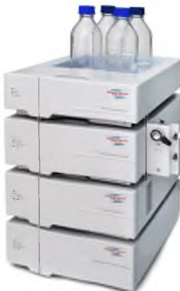
Рисунок 1. Общий вид одного из вариантов комплектации хроматографа «Хроматэк-Кристалл ВЭЖХ 2014»
