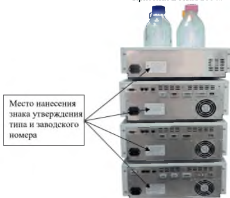
Рисунок 2. Общий вид хроматографа с указанием мест нанесения знака утверждения типа и заводского номера
